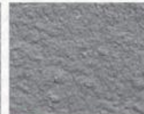
CSP 5 (medium-heavy shotblast)
